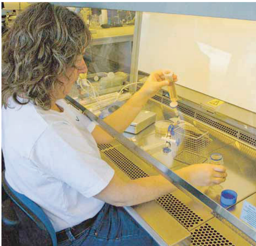
Laborant Laila Bleeg Smidt, Vitalys I/S, har udviklet en metode, der forbedrer detektionsgrænsen for bakterier i prøven med en faktor på 1000. Her tilføjer hun fermentet i posen en næringsbouillon med en kanyle ned gennem prøveudtagningsmembranen i posen.
